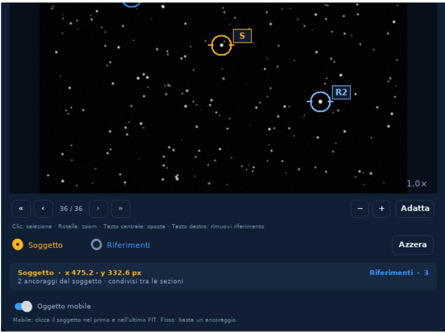
Figura 32. Ultimo frame demo: l’ancoraggio va sullo stesso oggetto. La previsione intermedia usa i tempi reali, non un passo fisso fra file.
